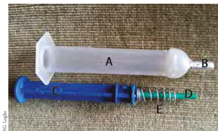
Foto 3. Componenti del "raccolgi pane d'api": (A) corpo della siringa; (B) tubicino rigido; (C) stantuffo; (D) barretta a sezione cilindrica; (E) molla.
